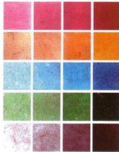
La cantidad de pigmento suele ser entre un 2% y un 6% con relación al peso del cemento. Eso significa que por cada 100kg. de cemento, se añade entre 2kg y 6kg de pigmentos.
