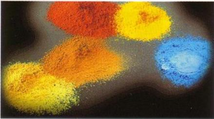
Su uso es muy sencillo: basta añadir un poco de pigmento a la batidora al momento de hacer la mezcla del concreto y listo para aplicar. Esta mezcla de cemento con color se puede usar en muchas formas. En las próximas ediciones de TYT me propongo compartir con usted cómo se usan estos pigmentos en aplicaciones tales como: adoquines, bloques decorativos, mosaicos, terrazos, concreto premezclado, repellos, pisos, adornos, entre otros.
